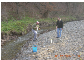
Euromax personnel take water sample for on site measurement and laboratory analysis. / Опробване на водоизточници за локално измерване и лабораторен анализ
