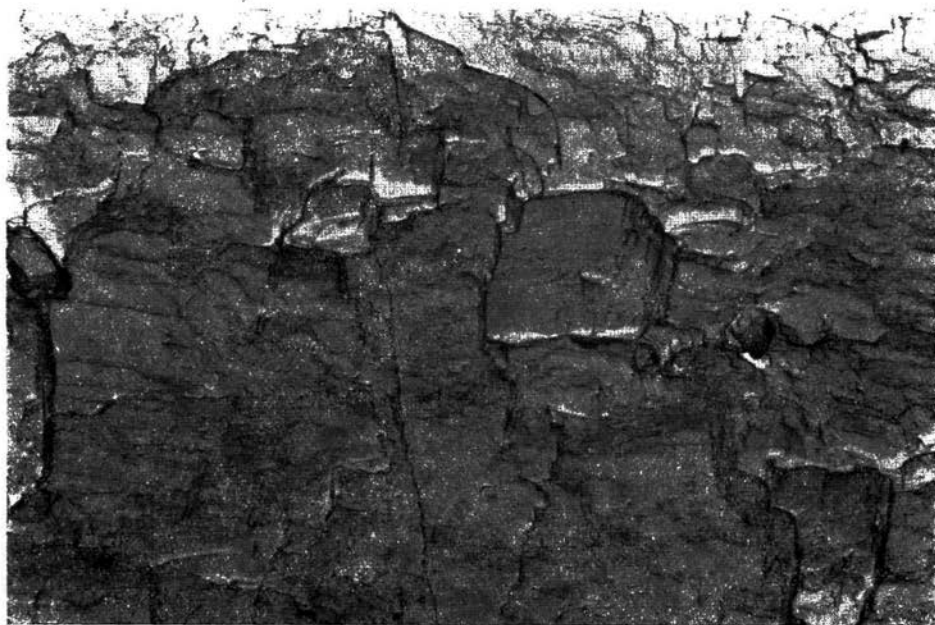
Фиг. 1. Повърхнинна на разцепване във финозърнист бял мрамор; електронен микроскоп, \times 4500
