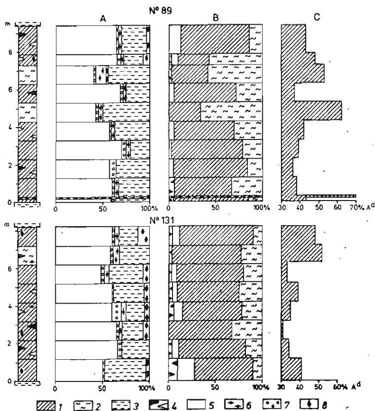
Фиг. 1. Петроложка характеристика на въглища от сондажи № 89 и № 131, Самоковски басейн: А. Мацерален състав, В. Микролитотипен състав, С. Пепелно съдържание
