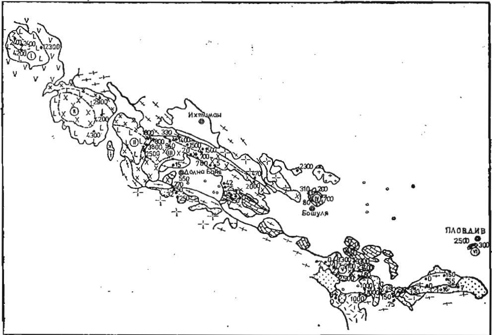
Фиг. 2. Карта на средните стойности на магнитната възприемчивост ( \chi \cdot 4\pi \cdot 10^{-6} \text{ SJ} ) в точките на опробване Условните знаци както на фиг. 1
