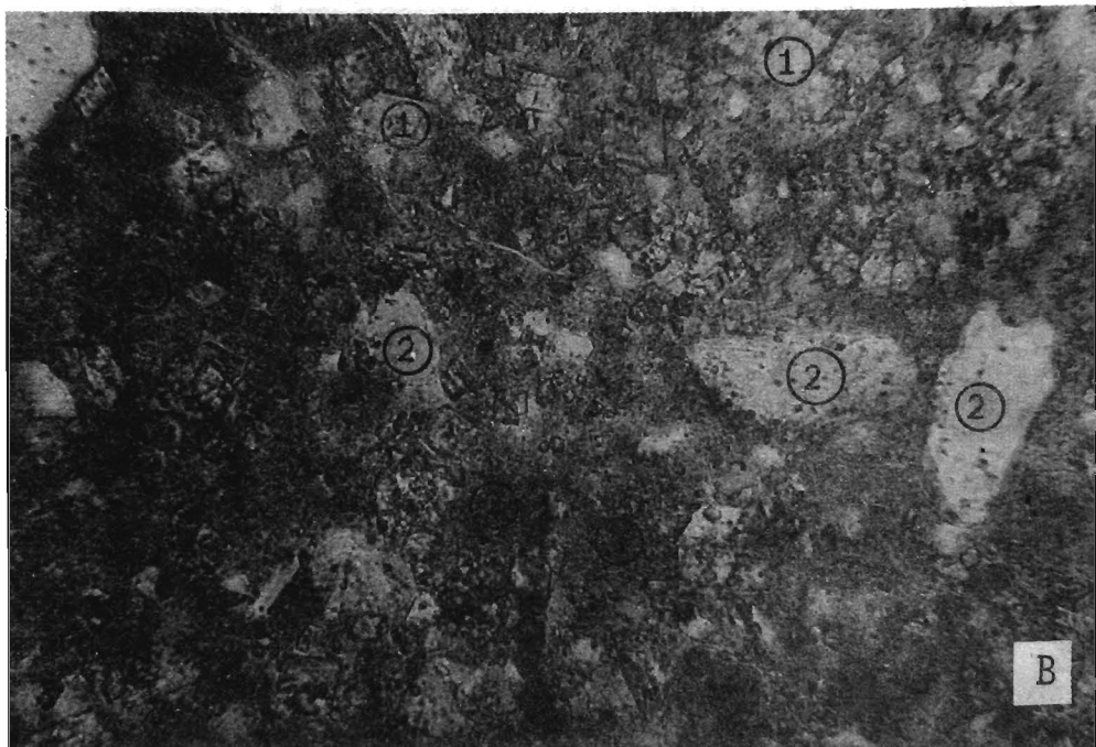
A. Marne riche en gypse. Gisement d'El Hadjia; S-60 du 64,3 m; gypse (1) — cristaux idiomorphes, masse principale (2) — foncée; \times 75 B. Marne fortement dolomitisée. Gisement d'Ain M'sekka-Est; S-103 du 41,9 m; dolomite (1) — cristaux rom biques, quartz (2), masse principale argilocarbonatée (3); \times 175
