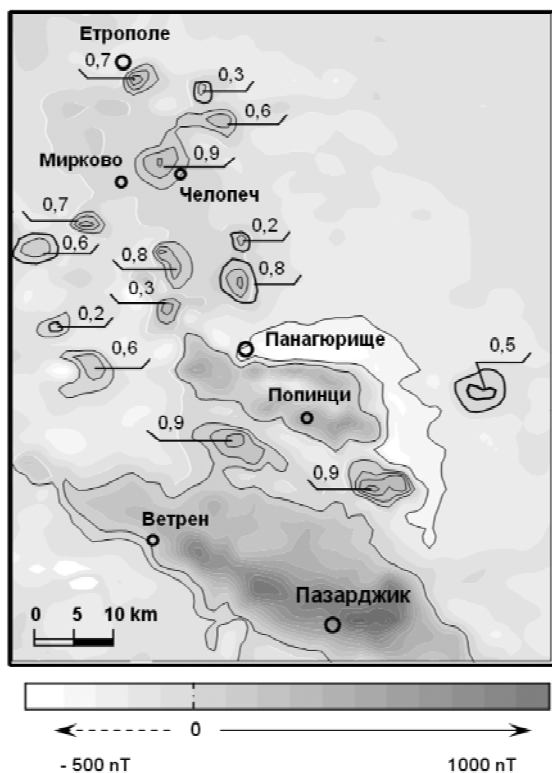
Фиг. 10. Схема на основните локални положителни геомагнитни аномалии в район от Централно Средногорие и дълбочина (в km) до центъра на аномалообразуващите магнитоактивни маси
