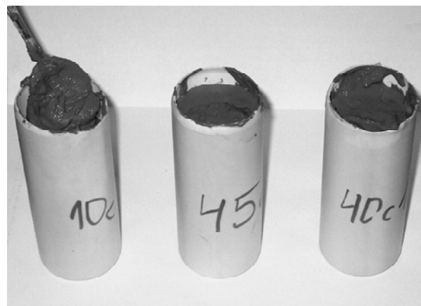
Фиг. 1. Приготвяне на цилиндрични пробни образци от циментопочвена смес с високо водно съдържание
