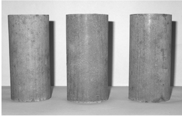
Фиг. 2. Пробни образци от циментопочвена смес след 28-дневно отлежаване
