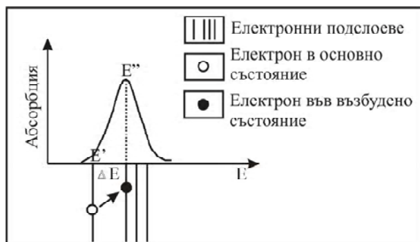
Фиг. 1. Схематично представяне на процеса, протичащ при взаимодействие на UV-VIS-NIR-светлина с атом. Електрон в основно състояние от подслой с енергия E' се възбужда в състояние от подслой с енергия E'' ( E'' > E' ) чрез поглъщане на енергия \Delta E (тази енергия, обозначена като \Delta , се нарича параметър на разцепване).
