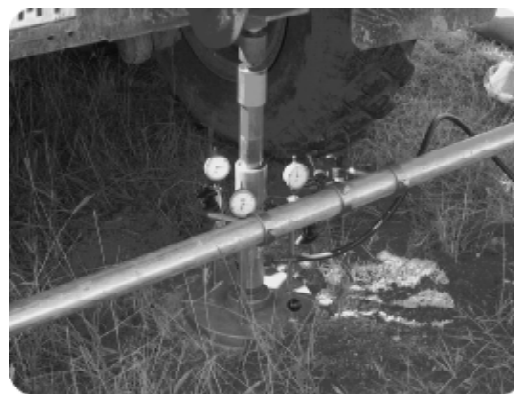
Фиг. 2. Комплект за пробно натоварване „Viatest“
