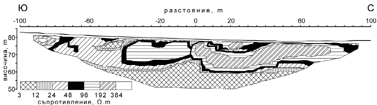
Фиг. 2. Геоелектричен вертикален разрез по профилна линия северно от Харманли. Мястото на профила е посочено със стрелка на фиг. 1. Разстояние между електродите 5 m.
